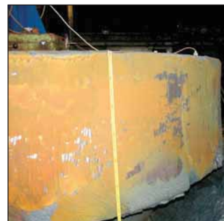
Рис. 6 Качество поверхности реза поковки из стали 09Г2С толщиной 630 мм с применением режущего кислорода под давлением 14 кгс/см 2
