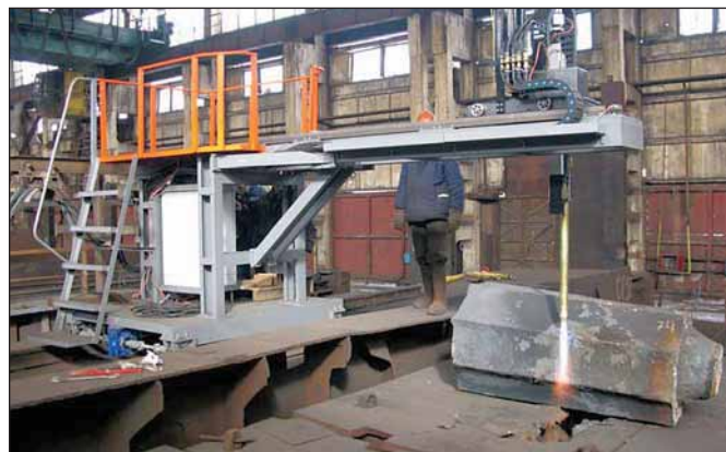
Рис. 2 Резка отливки из м/у стали толщиной 900 мм с применением кислорода низкого давления машиной газовой резки для копровых производств
