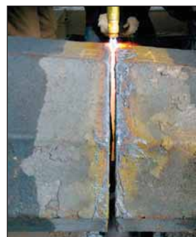
Рис. 3 Рез отливки из м/у стали толщиной 900 мм с применением кислорода низкого давления
