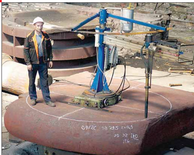
Рис. 4 Поковка из стали 09Г2С толщиной 630 мм перед резкой с применением режущего кислорода под давлением 14 кгс/см 2
