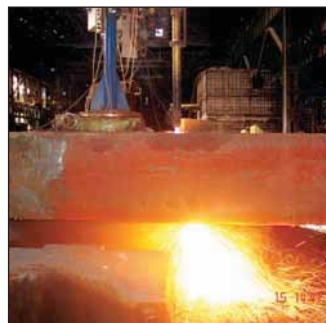
Рис. 5 Резка с применением кислорода под давлением 14 кгс/см 2 поковки из стали 09Г2С толщиной 630 мм
