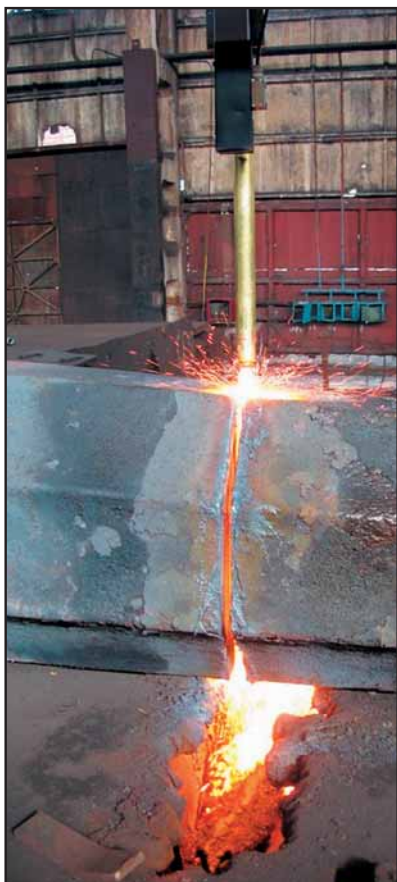
Рис. 3 Машина кислородной/кислородно-флюсовой резки стали для копрового производства
