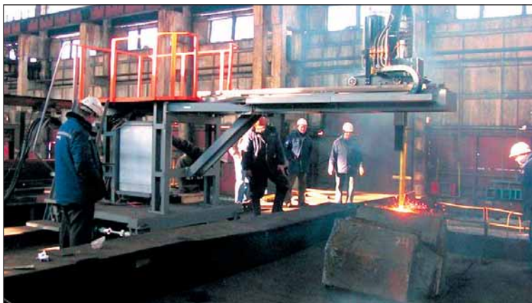
Рис. 3 Машина кислородной/кислородно-флюсовой резки стали для копрового производства
