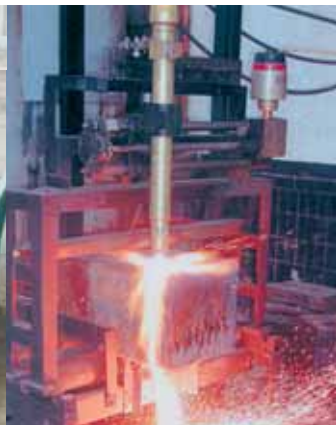
Обработка на испытательном стенде технологий кислородной резки блюмов (материал рельсовая сталь, сечение бьюма 300x330 мм).
