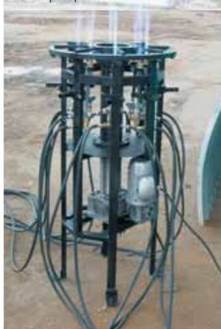
Установка для высокотемпературной пайки роторов
